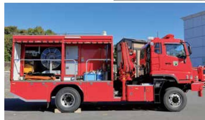
車両に積んであるポンプで、大量の水をくみ上げる。
