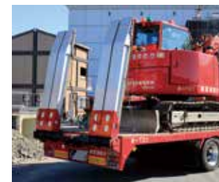
車体の後ろの車体昇降装置を地面につけ、スロープをつくって重機をおろす。
