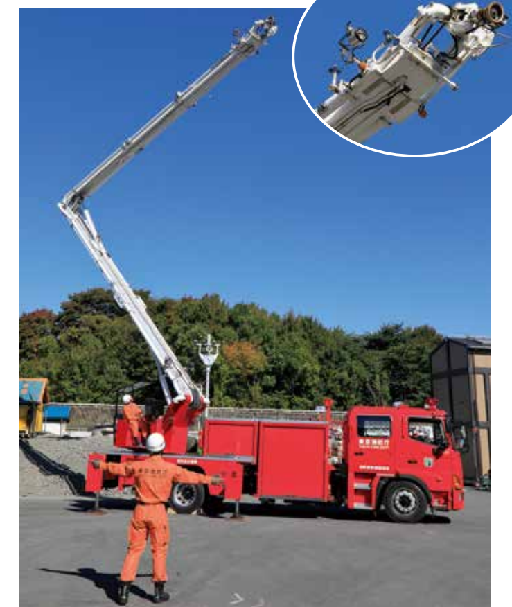
車両の後ろにある操縦席から、放水塔を操作する。放水塔は最大で22mの高さまでのばせる。
