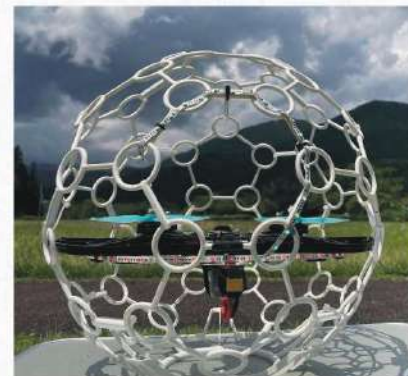
▲ドローンサッカー®で使われる、ドローンにフレームをつけたドローンボール。
